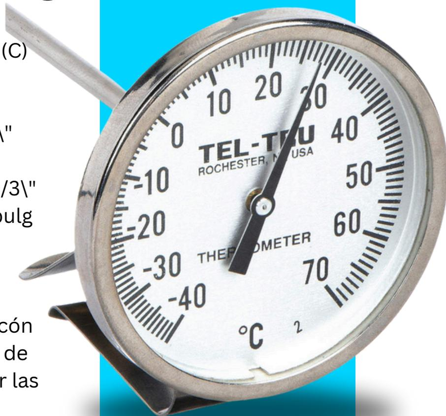
**Un Termómetro de laboratorio Bimetal es un dispositivo que utiliza el principio de dilatación diferente de dos metales diferentes para medir la temperatura**
