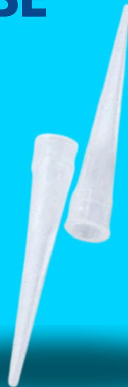
Estas puntas están diseñadas para ajustarse perfectamente al cono de la micropipeta, lo que garantiza un sellado hermético y evita fugas o contaminación cruzada durante la manipulación de las muestras.
