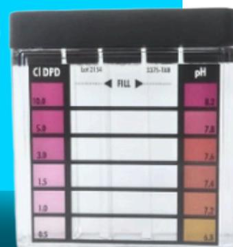
es una solución completa diseñada para medir los niveles de cloro libre y pH en piscinas y spas. Utiliza un comparador colorimétrico visual y tabletas reactivas para proporcionar resultados precisos y rápidos.
