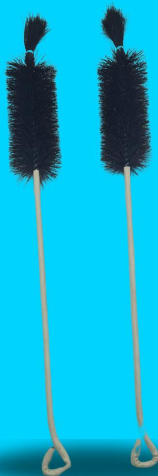
es un utensilio de laboratorio en el que consiste de un cepillo de manera alargada. Este utensilio de limpieza usado en laboratorio, está diseñado para limpiar superficies que se complica el acceso.
