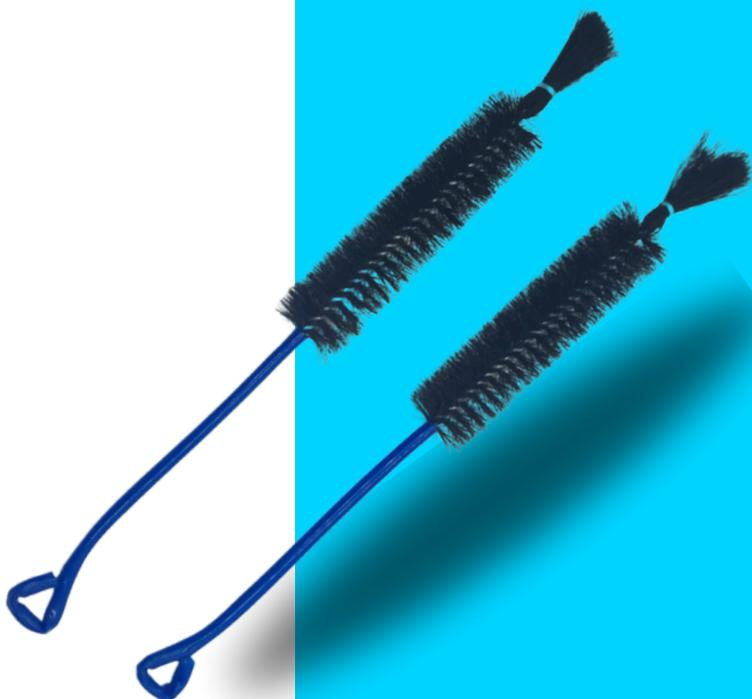
es un utensilio de laboratorio en el que consiste de un cepillo de manera alargada. Este utensilio de limpieza usado en laboratorio, está diseñado para limpiar superficies que se complica el acceso.
