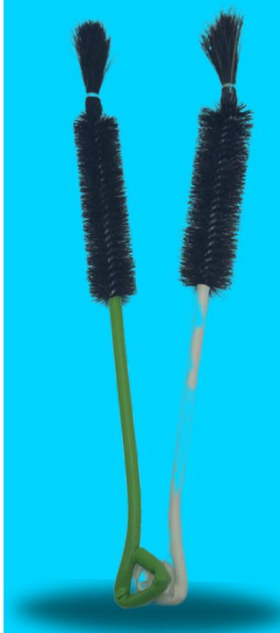
es un utensilio de laboratorio en el que consiste de un cepillo de manera alargada. Este utensilio de limpieza usado en laboratorio, está diseñado para limpiar superficies que se complica el acceso.
